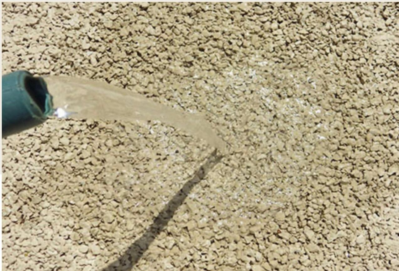
Le Béton Drain représente une avancée pour les projets d'aménagement extérieur. Ce matériau innovant, sans joints ni raccords, offre une surface continue qui prévient les fissures et la séparation, augmentant ainsi sa durabilité et sa résistance à l'érosion. Grâce à sa capacité de perméabilité, il favorise l'absorption des eaux de pluie, réduisant le ruissellement et minimisant le risque d'inondations.
